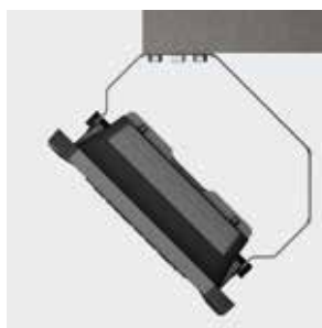
Montering på udvendigt hjørne
